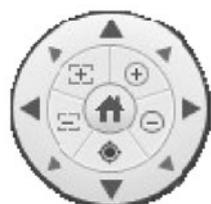
Mit der PTZ Schaltfläche können Sie mühelos PTZ-Kameras steuern.
